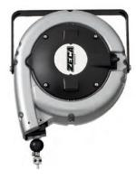
Il Rotolift è dotato di un dispositivo di arresto della fune e consente di avvolgere una fune d'acciaio, dalla quale si possono sospendere oggetti che vengono abbassati sulla superficie di lavoro solo per la durata di utilizzo. Dopo l'uso, questi oggetti possono essere sollevati dall'area di lavoro rilasciando il dispositivo di blocco. Il cavo d'acciaio (ø 3 mm) è racchiuso in una guaina di nylon trasparente ø 6 mm.
